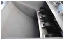
L'entrée tangentielle dans la chambre de coupe associée à un design agressif du rotor permet d'absorber les pièces volumineuses sans effort. La paroi arrière courbée de la chambre de coupe réduit la stagnation des pièces.
