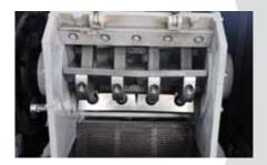
La chambre de coupe est intégrée dans un caisson insonorisé et permet une implantation en atelier. Le rotor et la grille sont facilement accessibles pour les opérations de nettoyage et de maintenance.
