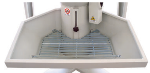
Détail de la trémie d'alimentation
