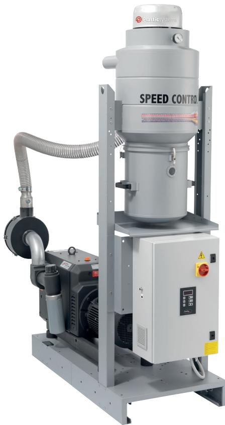
Les unités d'aspiration des séries PM, d'une puissance comprise entre 3 et 30 kW, peuvent être utilisées pour assurer le transfert pneumatiques de matière plastique. Les débits peuvent varier jusqu'à 4500 kg/h sur une distance atteignant les 200 m.
